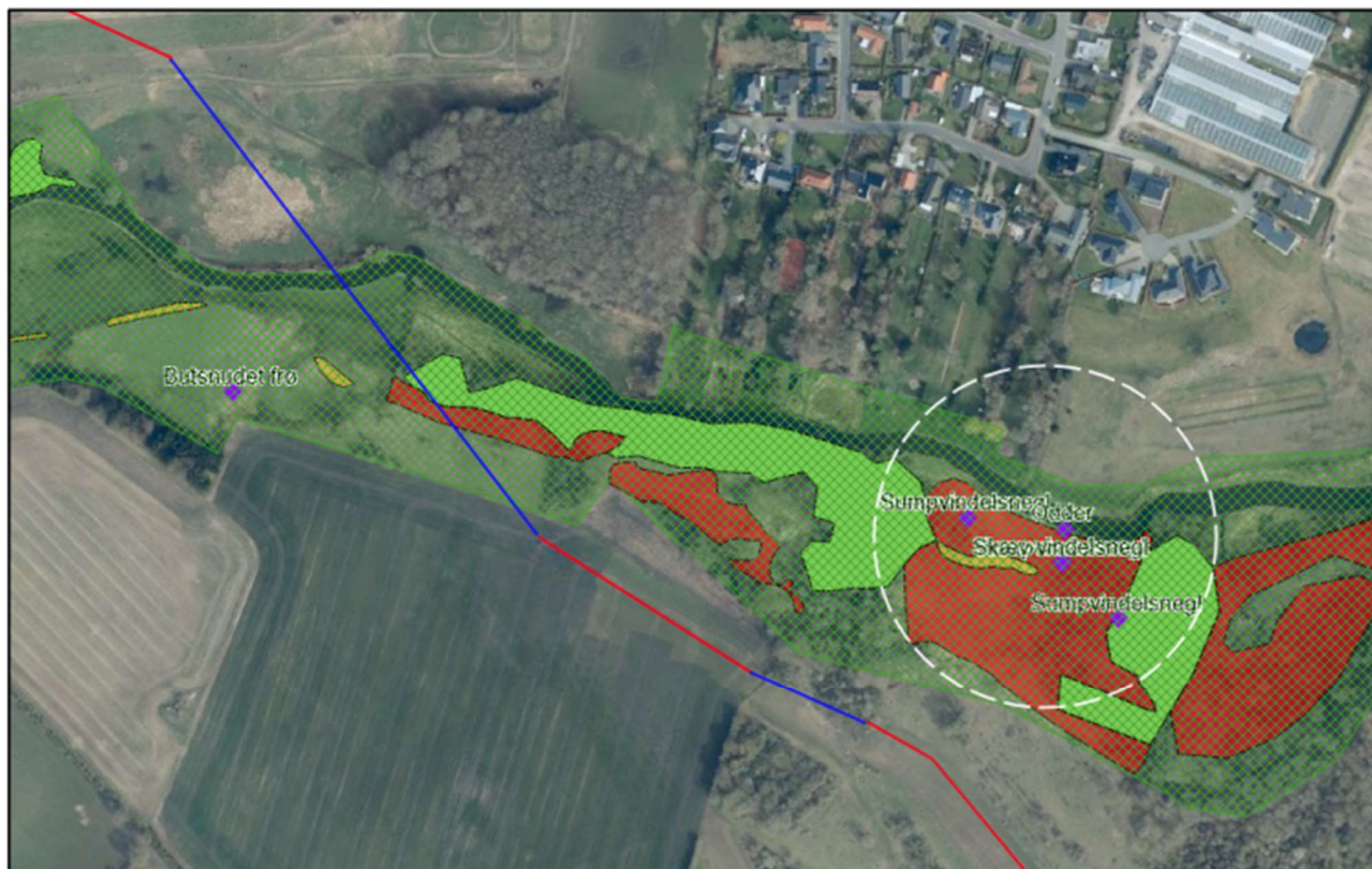
Figur 3: ledningstracéet med styret underboring (blå streg) og nedgravning (rød streg) i forhold til Natura 2000 (grønne tern), kildevæld (rød flade) og elle-askeskov (grøn flade), samt fund af sumpvindelsnegl og skævvindelsnegl (stiplet hvid cirkel), Datafordeleren 2023
