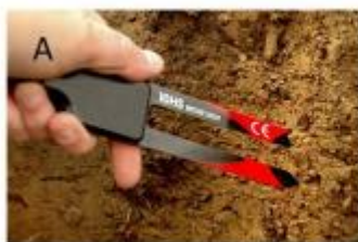
Bilag 3 Billeder af måleudstyr som ønskes installeret ved de 15 målepunkter og i prøvehullet: A) Sensorer til måling af vandindhold, B) Sensorer til måling af jordtemperatur, C) Datalogger til brug ved de 15 målepunkter, D) Kasse til måleudstyr ved prøvehul og E) Vejrstation.
