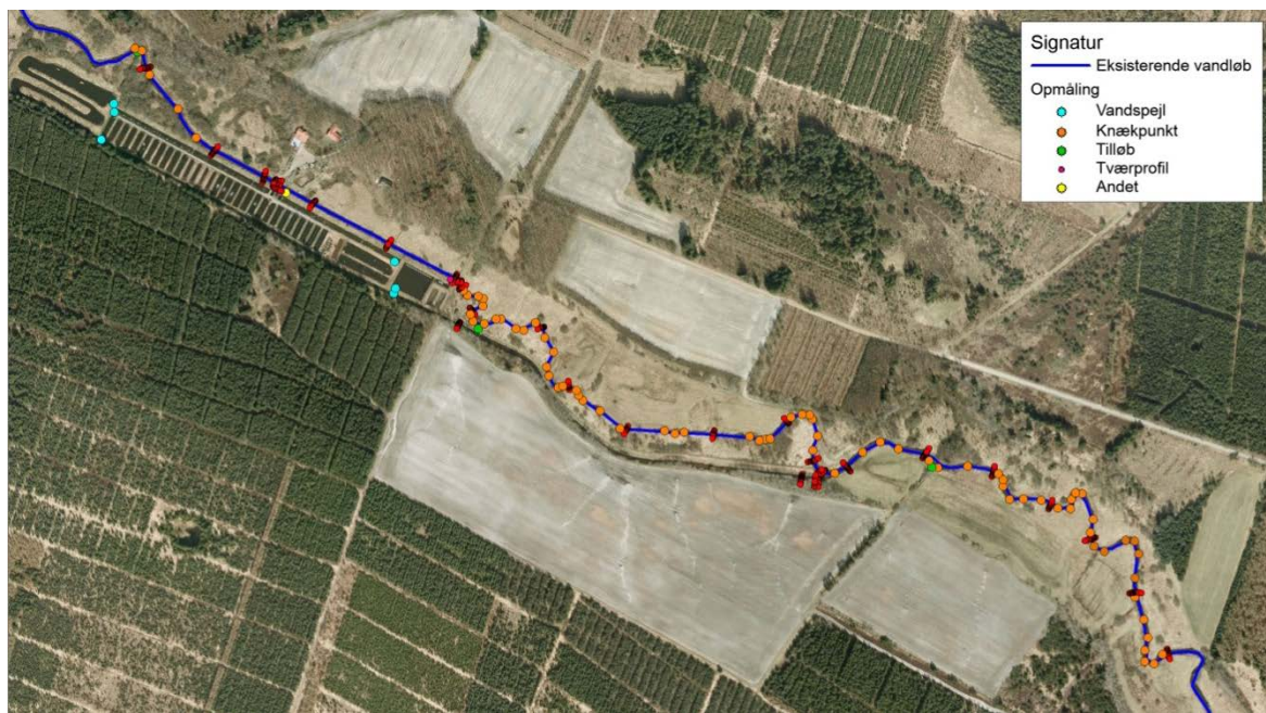
Figur 6 Opmålt vandløbsstrækning og opmålte punkter i forbindelse med dambruget, se Bilag 7 (©Geodatastyrelsen)
