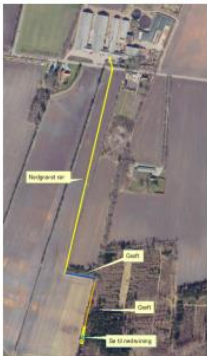
Figur 1. Grøft og nedslivningsbassin.
