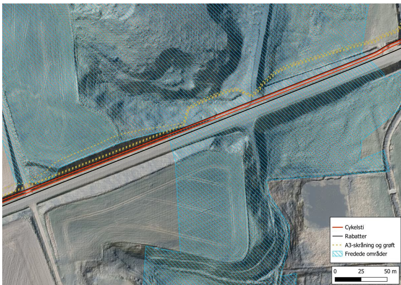
Figur 2-3 Oversigt på skyggekort over projektets berøring med arealer, der er omfattet af fredningen af Tindskov Bakker. Terrænet indenfor det fredede område varierer meget, og etableringen af A3-skråningsanlæg forudsætter således både afgravning og påfyldning af jord. Målestok: 1:1.300.
