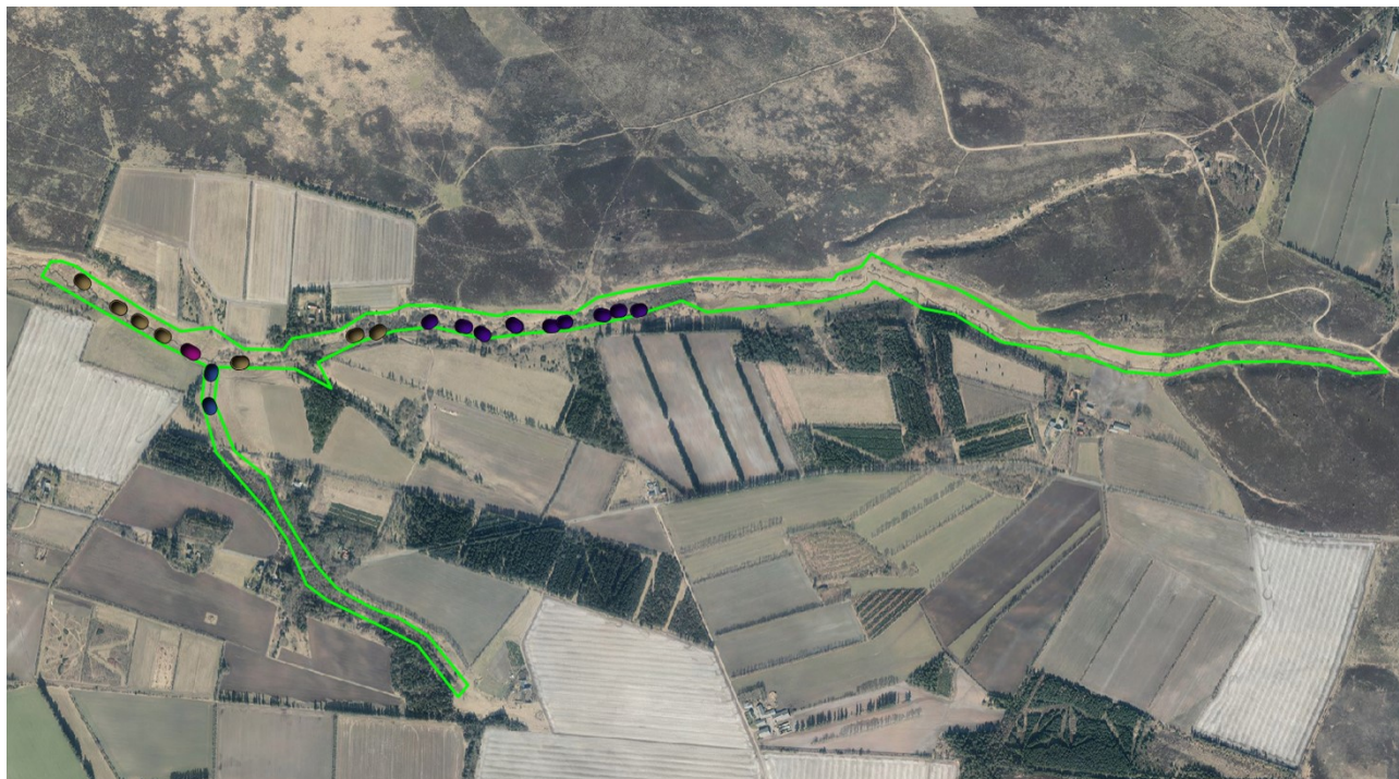
Figur 6. Udlægning af gydegrus og skjulesten Vandområdet er vist med grønt.
