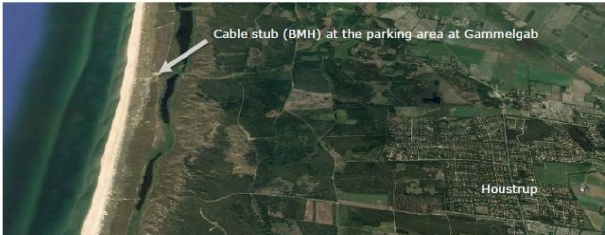
Figur 3-1 Gammelgab strand parkeringsplads hvor anlægsarbejderne (underboring under klitter til havet, etablering af BMH og jordspyd) i forbindelse med kabelstykket (fra grænsen mellem dansk territorial- og international farvand og op til parkeringspladsen Gammelgab), er planlagt at foregå.
